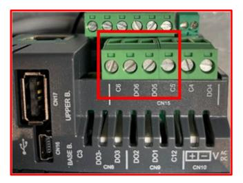
B larm = slutning mellan plintar C5-DO5 A larm = slutning mellan plintar C6-DO6
